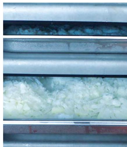
Zur Trocknung bereit: Granuliertes Milcheis auf einem Tray formatiert
