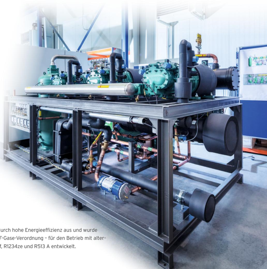
Die ECOPRO 2.0-Serie zeichnet sich durch hohe Energieeffizienz aus und wurde - im Sinne des „Phase down“ gemäß F-Gase-Verordnung - für den Betrieb mit alternativen HFO-Kältemitteln wie R1234yf, R1234ze und R513 A entwickelt.
