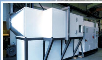
BRASILIE - Lufttrocknungsanlage für eine Lackmühle
