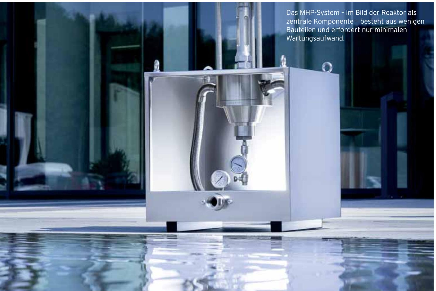
Das MHP-System - im Bild der Reaktor als zentrale Komponente - besteht aus wenigen Bauteilen und erfordert nur minimalen Wartungsaufwand.
