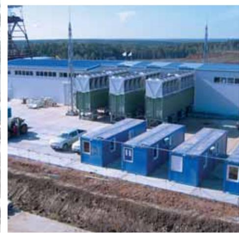
Perm - Bodengefrieranlage erleichtert das Teufen
