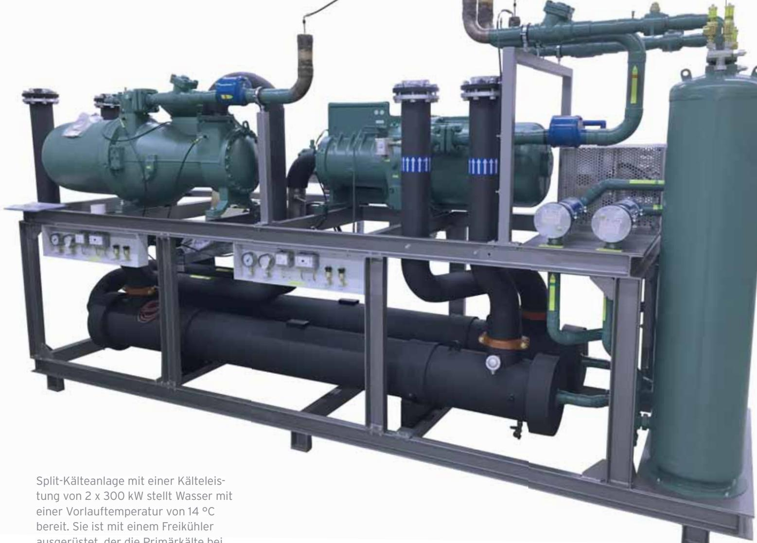
Split-Kälteanlage mit einer Kälteleistung von 2 x 300 kW stellt Wasser mit einer Vorlauftemperatur von 14 °C bereit. Sie ist mit einem Freikühler ausgerüstet, der die Primärkälte bei niedrigeren Außentemperaturen aus der Umgebung bezieht. Das entlastet die Kältemaschine ganz wesentlich.
