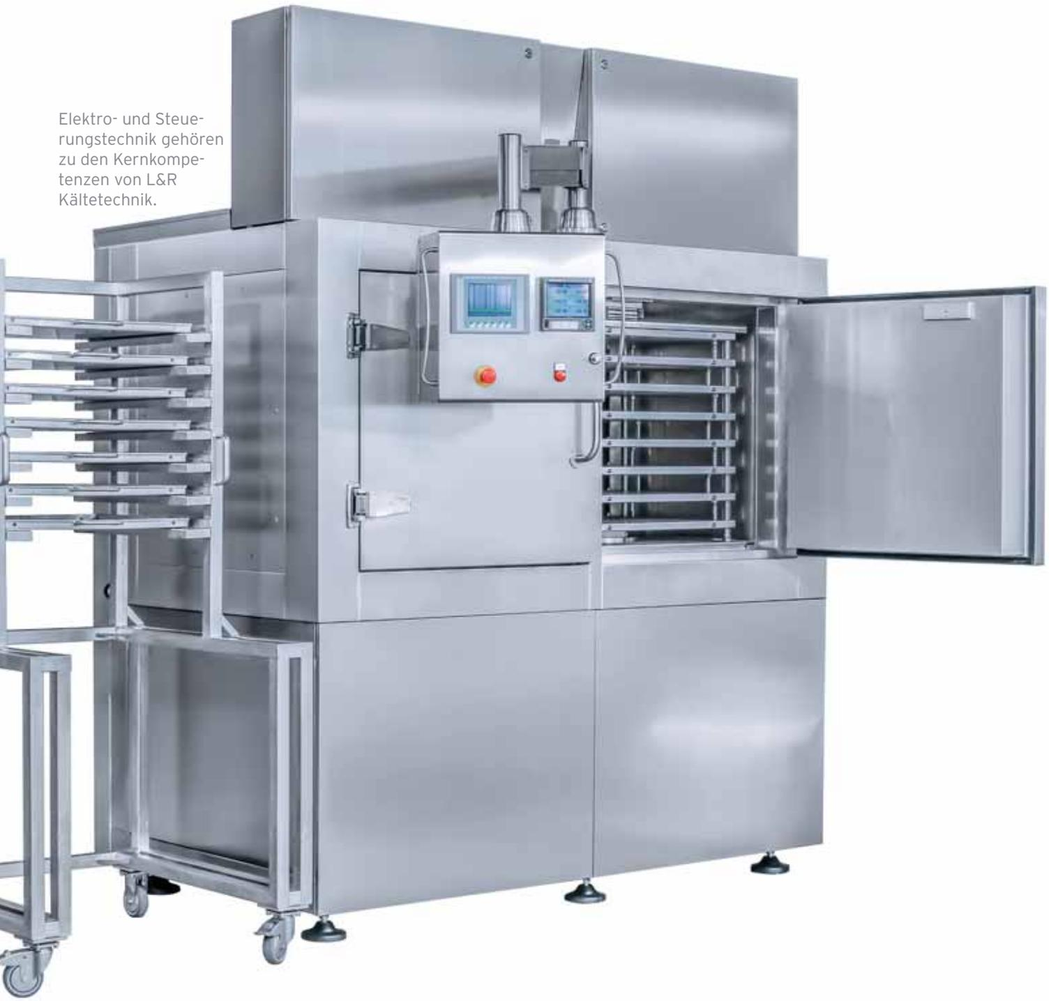
Die Beutel mit Blutplasma werden zwischen die Kontaktplatten eingelegt, die zusammenfahren und eine schnelle Kälteübertragung gewährleisten.
