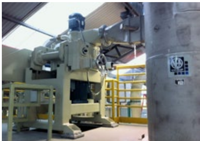
ICM-Prallsichtermühlen von Neumann & Esser kommen weltweit in der Pulverlackproduktion zum Einsatz.
